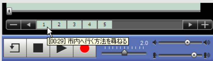
設定するには「メモ」を付与したいブックマーク番号ボタンの上で右クリックし、「編集」メニューを選びます。「ブックマーク編集」ダイアログが表示されるので、テキストを入力し [更新] ボタンをクリックします。テキスト内容が保存され、マウスカーソルを合わせるとブックマーク位置の時間と入力したテキストが表示されます。
