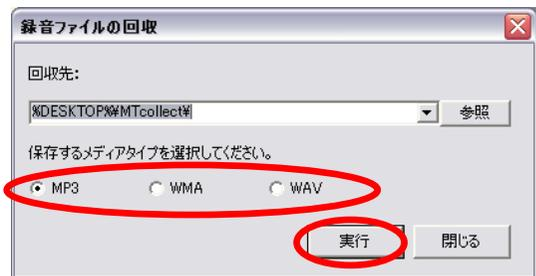
指定したフォルダに、回収日時の名前がついたフォルダ「YYYYMMDDhhmmss」が自動で作られ、学習者ムービーテレコで直前に録音したマイク音声が一緒にコピーされます。このため、回収先として同じフォルダを指定して何度か回収を実行しても区別して保存できます。
