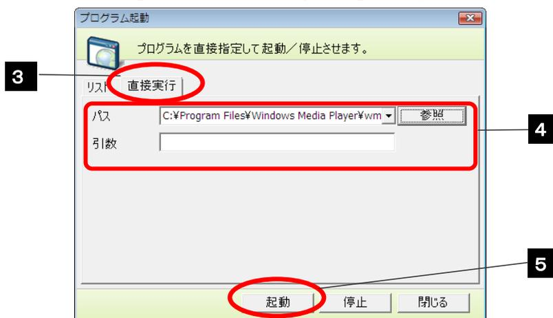
4. 「パス」に起動させるプログラム名を絶対パスで入力します。または [参照] ボタンをクリックしてプログラムを選択します。
