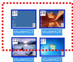
マウスをドラッグ（左ボタンを押したまま斜めに移動する操作）すると、クラスエリアに矩形が表示されます。クラスエリアの床部分（何も表示されていない部分）を始点としてマウスをドラッグし、矩形を描くと、矩形にかかったすべての座席が選択状態になります。
